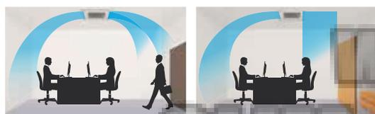
Diffusion d'air optimisée en évitant le soufflage direct d'air froid et en fournissant des flux d'air oscillant en même temps.
