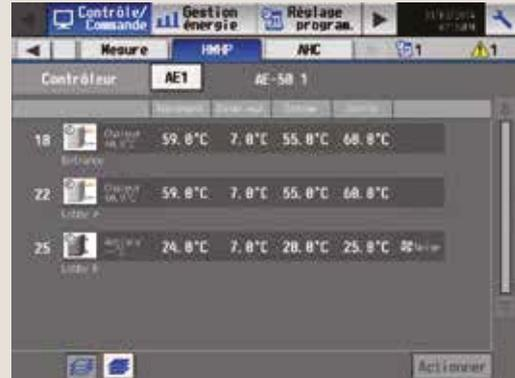
Les valeurs représentatives de la température de l'eau, de la température extérieure, de la température de l'eau en entrée et de la température de l'eau en sortie seront affichées.
