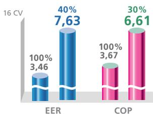
Les compresseurs DC Inverter double rotor présentent l'avantage d'être particulièrement performants à charge partielle.
