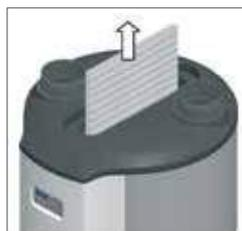
Le filtre se change simplement en enlevant la partie centrale du capot et en tirant le filtre par le haut.
