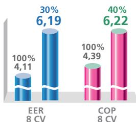
Les compresseurs DC Inverter double rotor présentent l'avantage d'être particulièrement performants à charge partielle.
